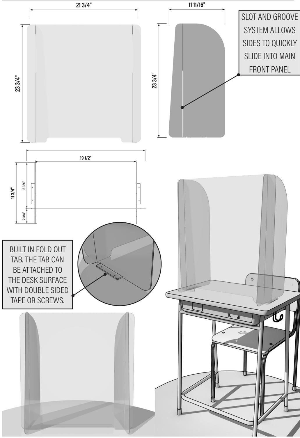
SLOT AND GROOVE SYSTEM ALLOWS SIDES TO QUICKLY SLIDE INTO MAIN FRONT PANEL
